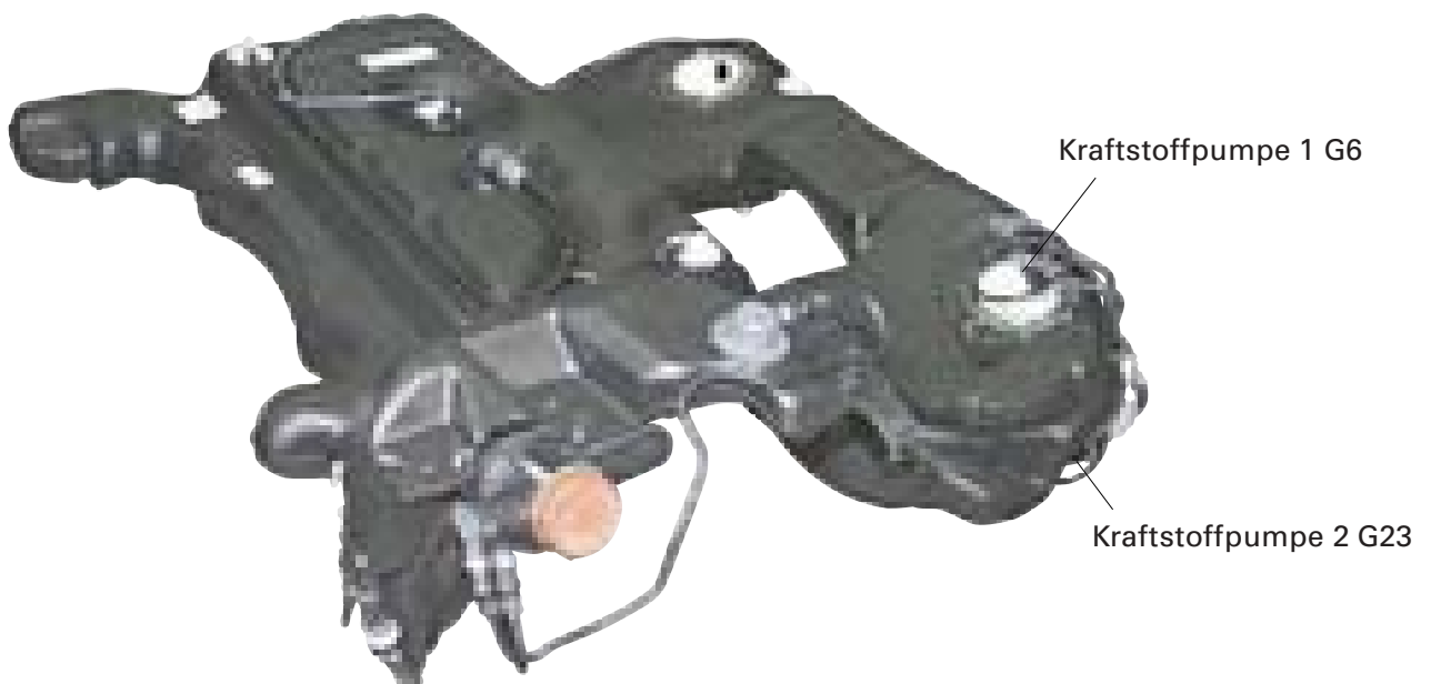
Kraftstoffbehälter mit externer Zusatzkraftstoffpumpe
